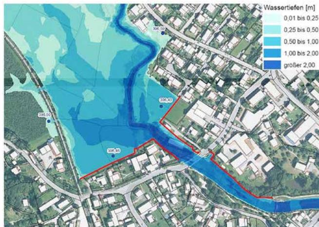
Abbildung 3.6: Wassertiefen des Planungszustandes bei HQ<sub>100</sub>
