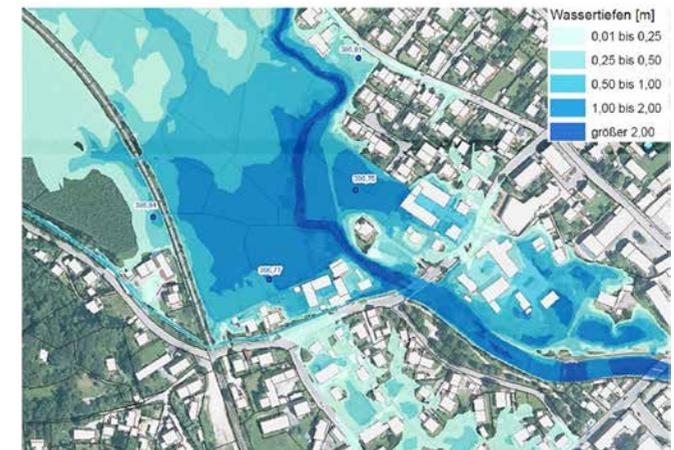
Abbildung 3.5: Wassertiefen des Ist-Zustands bei HQ<sub>100</sub>
